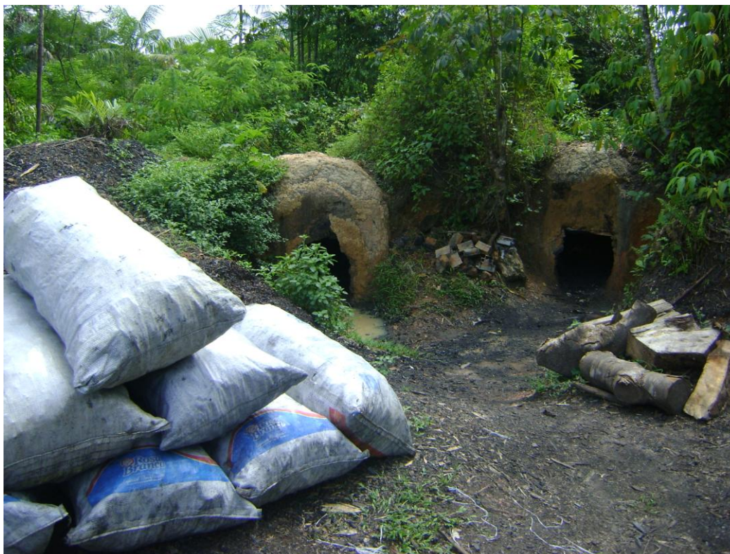
FOTO 16 - PRODUÇÃO DE CARVÃO: dois fornos usados para a produção do carvão. Quando é terminada a queima, as sacas são colocadas na beira do caminho. Foto: José Luiz Sirotheau (12/02/2012).
